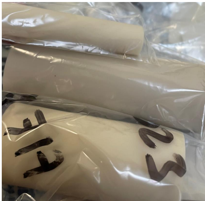
図 1:オリジナルのソースオイルおよび2番目のソースオイルで作られたチューブ色の違い
